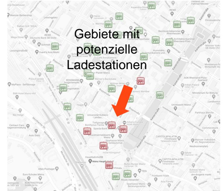
*Räumliche Darstellung der gemessenen Netzknotten. Rot: Knoten mit den häufigsten harmonischen Überschreitungen, die möglicherweise mit dem Vorhandensein einer Ladestation zusammenhängen.*
